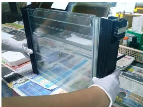
ภาพผนวกที่ 6 การประกอบกระจก เข้ากับ chamber
