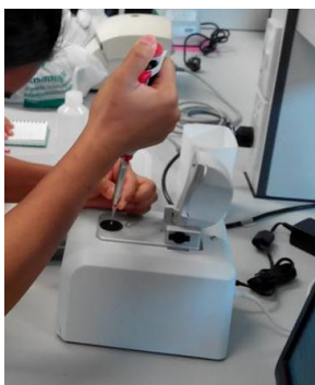
ภาพผนวกที่ 4ก การวัดความเข้มข้นของดีเอ็นเอด้วยเครื่อง Nanodrop2000
