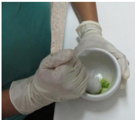
ภาพผนวกที่ 1ก การบดใบอ่อนยางพารา ใน 2x CTAB buffer (Extraction buffer)
