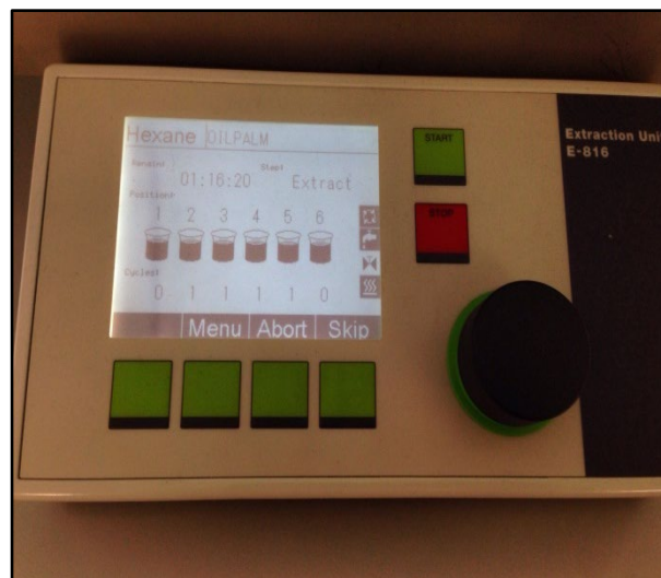
ภาพที่ 3.7 การทำงานของเครื่องสกัดไขมันมี 3 ขั้นตอน คือ สกัด 30 นาที ล้างตัวอย่าง 30 นาที และทำให้ตัวอย่างแห้ง 30 นาที
