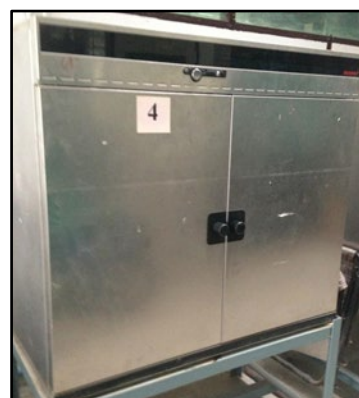
ภาพที่ 3.9 นำไปเข้าตู้อบที่อุณหภูมิ 80 องศาเซลเซียส นาน 1 ชั่วโมง
