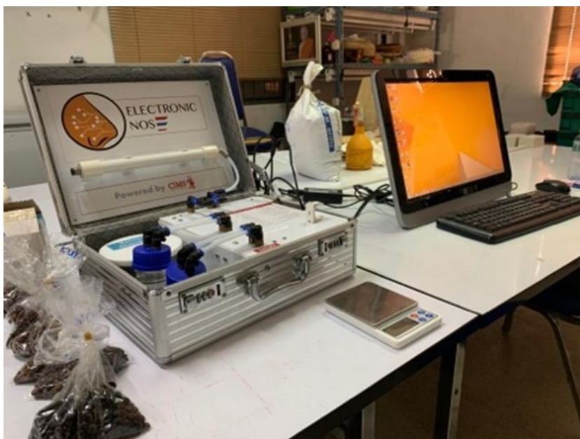
ภาพที่ 7 การวัดกลิ่นด้วยเครื่อง electronic nose
