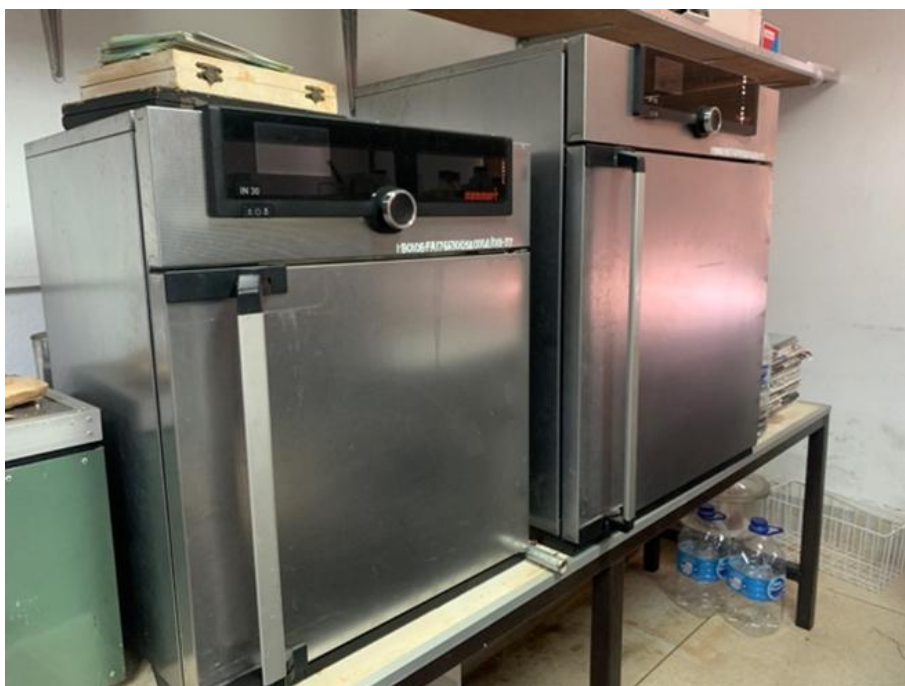
ภาพที่ 3 การอบเมล็ดกาแฟด้วยตู้อบลมร้อน
