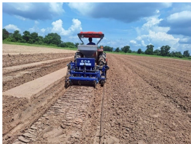
ภาพผนวกที่ 2 ปลุกด้วยเครื่องหยอดเมล็ดแบบพวงแทรกเตอร์ แบบ 3 แถว
