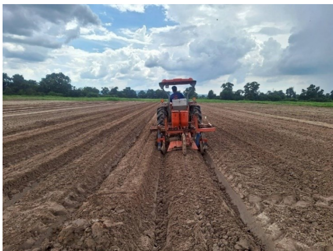
ภาพผนวกที่ 1 ปลุกด้วยเครื่องหยอดเมล็ดแบบพวงแทรกเตอร์ แบบ 2 แถว
