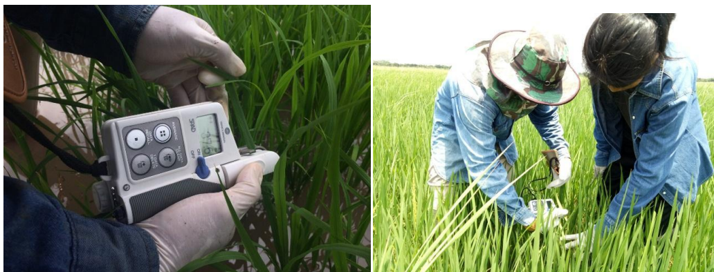
ภาพผนวกที่ 3 ภาพแสดงการวัดความเขียวทั่วทั้งใบจำนวน 3 จุด คือ กกใบ กลางใบ และปลายใบ ด้วยเครื่อง chlorophyll meter (SPAD-502)
