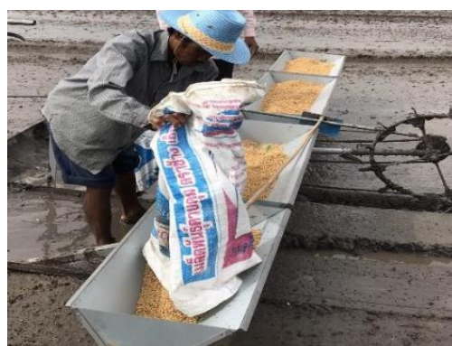
ภาพผนวกที่ 1 ภาพแสดงเมล็ดพันธุ์ที่ผ่านการเร่งการงอกโดยการแช่น้ำ สำหรับการปลูกแบบนาหว่านน้ำตมและการใช้เครื่องหยอดเมล็ด การนาเมล็ดใส่เครื่องหยอดเมล็ดและเครื่องหว่านพ่นแบบสะพายหลัง
