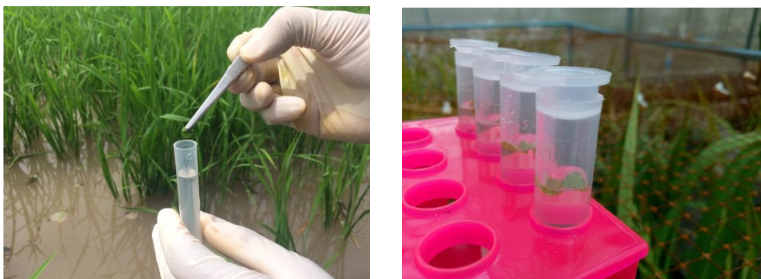
ภาพผนวกที่ 4 ภาพแสดงการสกัดคลอโรฟิลล์ในใบข้าว เจาะตัวอย่างใบบริเวณที่วัดความเขียวใบ ด้วย cork borer จะได้แผ่นใบรูปร่างวงกลม ใส่ในหลอดที่เติมสาร N,N-dimethylformamide (DMF) ปริมาณ 4 มิลลิลิตร
