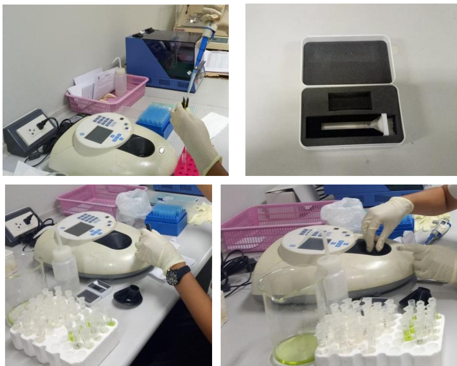
ภาพผนวกที่ 5 ภาพแสดงการนำสารละลายคลอโรฟิลล์วัดค่าการดูดกลืนแสง (absorbance, A) ด้วยเครื่อง spectrophotometer ที่ความยาวคลื่น 664 nm และ 647 nm
