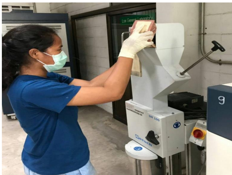
ภาพผนวกที่ 4 การบดตัวอย่างด้วยเครื่องบดตัวอย่าง
