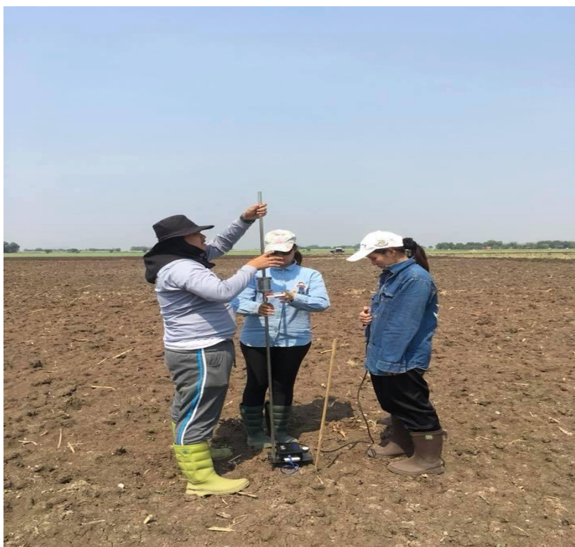
ภาพผนวกที่ 1 การเก็บค่าความต้านทานการแทงทะลุของดิน
