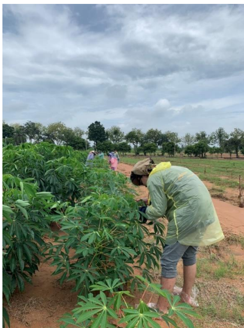
ภาพผนวกที่ 2 การใช้เครื่องวัดคลอโรฟิลล์รุ่น SPAD – 502 วัดใบมันสำปะหลังใบที่ 6 จากใบที่คลี่ ใบแรก ณ สถาบันพัฒนามันสำปะหลังห้วยบง จังหวัด นครราชสีมา
