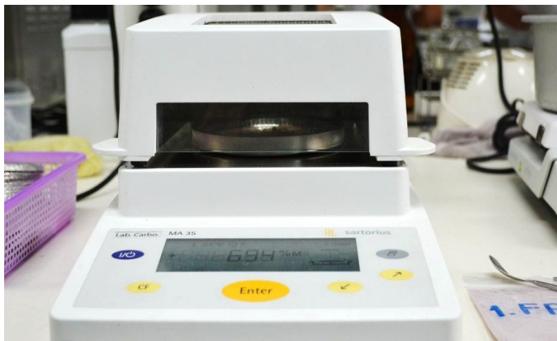
ภาพที่ 32 เครื่องหาความชื้นรุ่น MA 35
