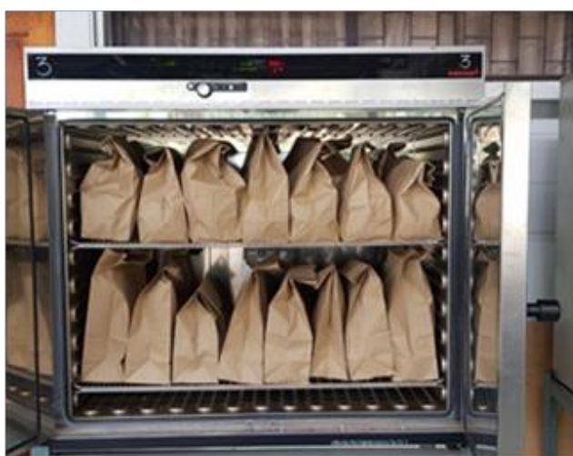
ภาพผนวกที่ 14 การอบแห้งด้วยตู้อบลมร้อน
