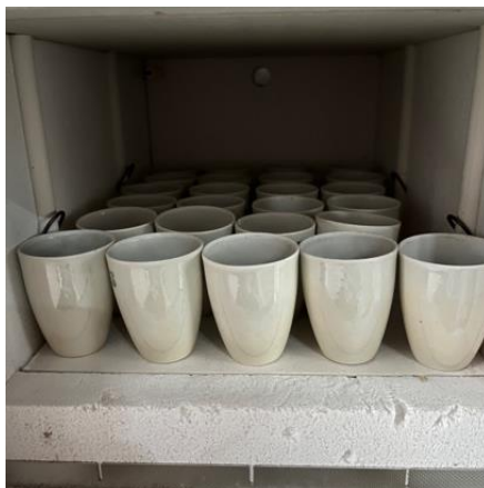
ภาพผนวกที่ 3 การวิเคราะห์ปริมาณเถ้าด้วยเตาเผาอุณหภูมิสูง (Ashing Furnace)
