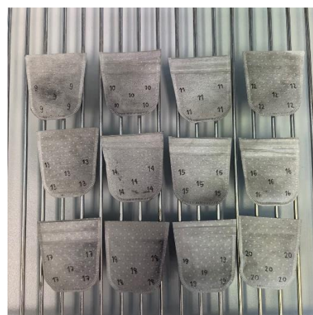
ภาพผนวกที่ 5 ตัวอย่างหลังจากวิเคราะห์ค่า NDF, ADF และ ADL
