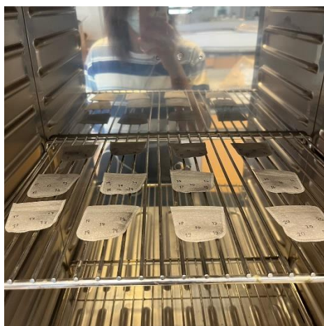
ภาพผนวกที่ 5 ตัวอย่างหลังจากวิเคราะห์ค่า NDF, ADF และ ADL
