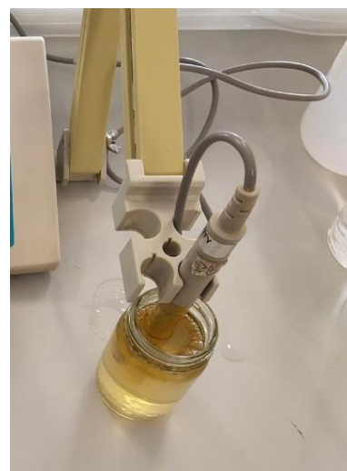
ภาพที่ 8 การหาค่าการนำไฟฟ้าด้วยเครื่องวัดการนำไฟฟ้า (Electrical conductivity Test)
