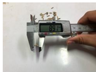
ภาพผนวกที่ 19 วัดความยาวด้วย digital vernier caliper
